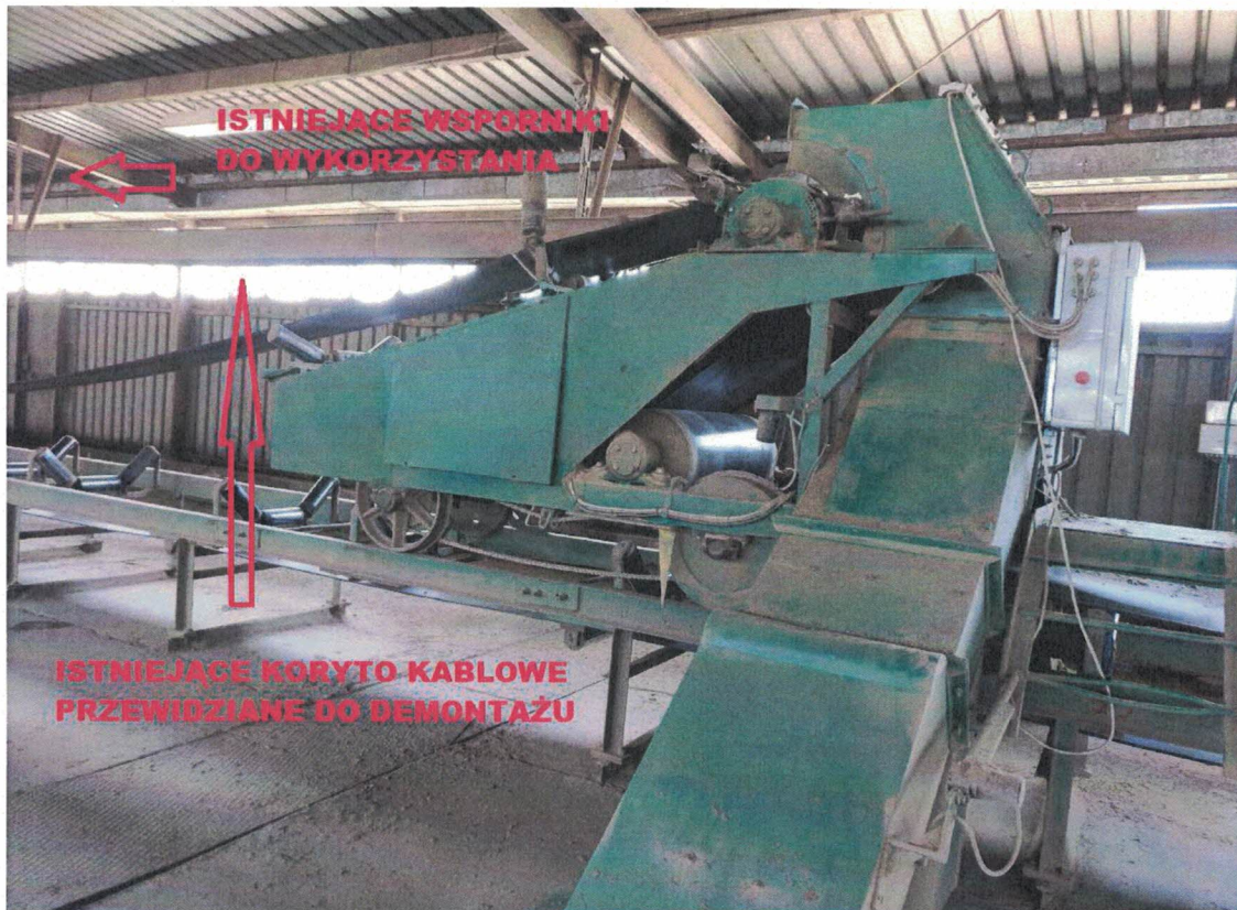
Rys. 1 Koryta kablowe przewidziane do demontażu.
